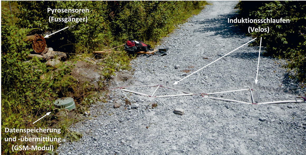
Abbildung 2: Kombinierte Zählstelle für Fussgänger und Velos.
